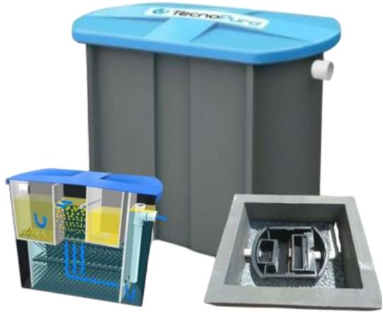
Fabricada com a finalidade de separar água e óleo com auxílio de placas coalescentes. Produzida em polietileno de alta densidade, proporcionando durabilidade e resistência a impactos. Apresenta um sistema coletor de óleo ajustável de acordo com o nível de óleo, eliminando a necessidade de depósito de óleo externo. Um cesto de retenção de sólidos separa as partículas no cesto coletor, facilitando o processo de manutenção.
